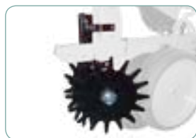
Repartidor de residuos rotante.
